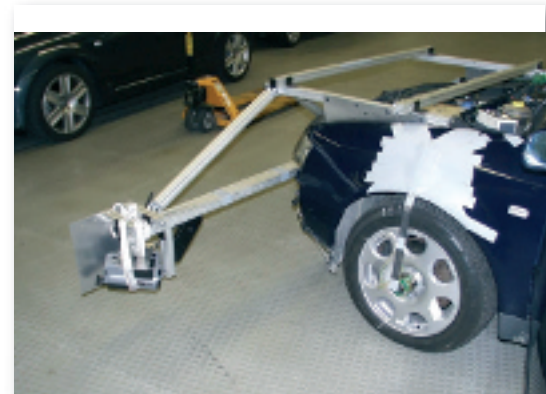
横揺れ抵抗とその他タイヤの機能を測定する赤外線カメラ
