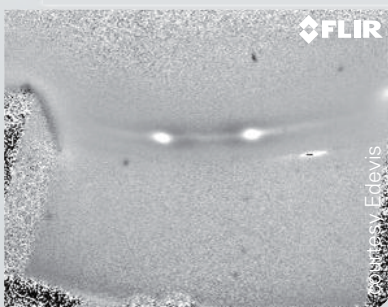
誘導体の亀裂検出
