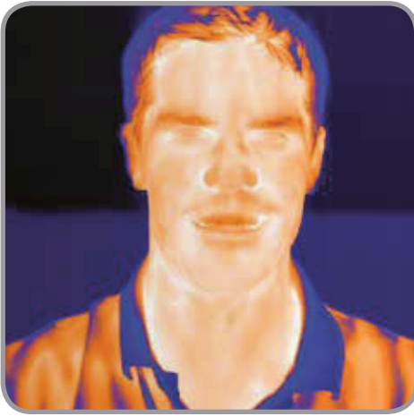
図12: 1024×1024ピクセルのInSb検出器を装備したカメラの熱画像
