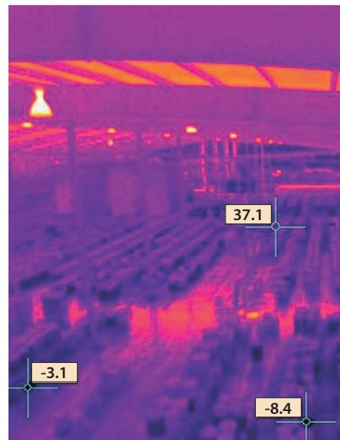
フリーシステムズの赤外線カメラFLIR A310は、計測した温度が事前設定値よりも高温であればアラームを作動させる
