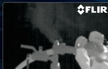
六フッ化硫黄漏れの光学ガス画像
