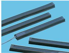
ケーブルスイッチは、スイッチ素子に導電ゴムと導電ワイヤーを組み合わせ、圧力を加えることで、抵抗値が $\infty$ から、 $\Omega$ 単位まで急変するA接点のスイッチです。単なる導電ゴムスイッチと異なり、導電ワイヤーを内蔵しており、長手方向への抵抗値の増大が少なく、フェイルセーフ機能を持たせることができます。また、独自の内部構造により、感度・耐久性・柔軟性に優れた信頼性の高い線状感圧センサの実現を可能としました。
