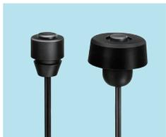
小型ゴムスイッチ M 型は、全体を高弾性ゴムで被覆した密封型感圧ゴムスイッチです。防水・防塵構造で、使用温度範囲も広いので、耐環境性に優れたボタンスイッチとして屋外使用も可能です。衝撃に対して極めてこわれにくいスイッチ体となっています。形状もコンパクトであり、従来の防水マイクロ、リミットスイッチの代替として各種機器への組み込み用や車輛用等の一般産業用途から FA 用途まで、幅広く活用頂けます。
