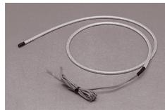
全方向ケーブルスイッチは、導電シリコンゴム電極と導電ワイヤーを一体押し出し成形した、全周囲方向から検知できるフレキシブルな長尺ゴムスイッチです。周囲から圧力を加えると、瞬時に抵抗値が $\infty$ から、200  $\Omega$ 以下まで急変しますが、導電ワイヤーを内蔵しているため、長手方向への抵抗値変化が無く自己診断機能付のフェイルセーフ設計も可能なA接点型のゴムスイッチです。全方向検知のため任意に長尺での設置・内蔵が可能となり、独自のオール弾性体構造により、感度・柔軟性・信頼性にも優れているため、FA/安全分野等で幅広く活躍いただけます。
