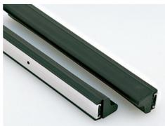
L型ケーブルスイッチは、導電シリコンゴムと導電ワイヤーを、独自のL型形状で一体押し出し成型した、全方向検知可能な電極体を丈夫なカバーゴムに内蔵した長尺ゴムスイッチです。周囲から圧力を加えると、瞬時に抵抗値が $\infty$ から、100  $\Omega$ 以下まで急変します。また、導電ワイヤーを内蔵しているため全長において抵抗の変化がほとんど無いので、自己診断機能付のフェイルセーフ設計も可能なA接点型のオールゴムスイッチです。独自のオール弾性体構造により、全方向感度、耐衝撃性、防水性にも優れているため、「可動ドア部の挟まれ検知」等の安全対策分野で幅広く活用頂けます。
