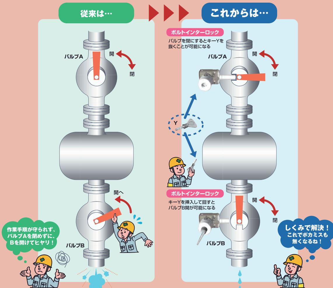
英国フォートレス社のトラップキー式インターロックスイッチ「mGard シリーズ」は、予め定義された操作シーケンスが必要な安全アプリケーションで電力遮断、キー交換、およびインターロック用に設計されたメカニカル式のインターロックです。危険な機械を点検する際に作業者の安全を確保し、万が一の事故を未然に防止するための安全スイッチです。
