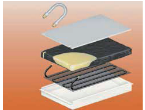
MeandRoシステムでは、穴のあいたシート状のスチールパネルと MeandRo管がサンドイッチ構造になっている。
