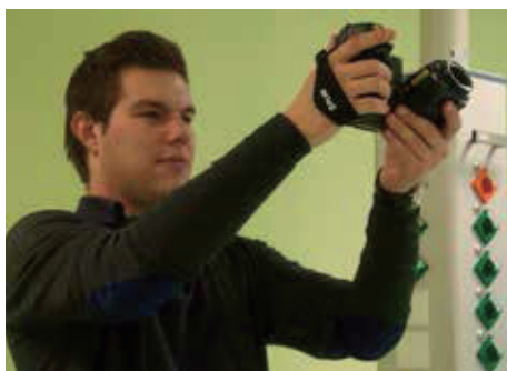
FLIR T440bxシリーズは、角度可変式のレンズユニットを搭載しており、楽な姿勢で検査や撮影ができる。
