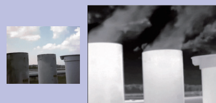
冷媒ガスの確認
