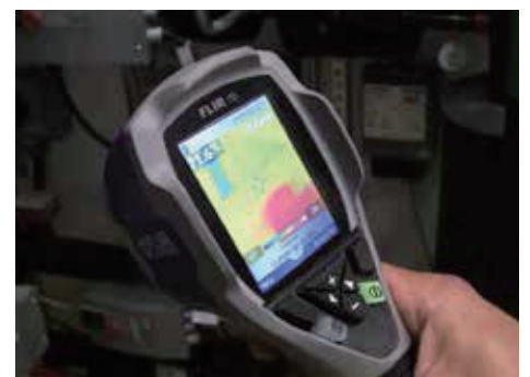
この多機能システムは、空調システムや建物の断熱材の検査など、様々な用途に使えます。
