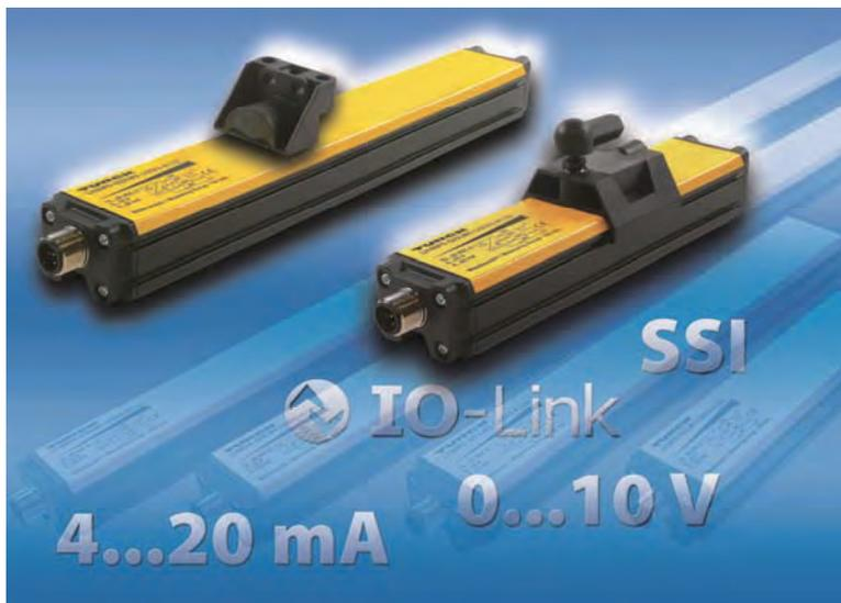
移動部とセンシング部の間に機械的接触がない非接触式リニア位置センサ。センシング面と移動部間で形成される電磁結合は、周囲の磁石や金属の影響を受けない為、安定した測定が可能。磁歪式センサと比較し耐衝撃性や耐振動性にも優れ設置環境が厳しい装置などにも対応。
