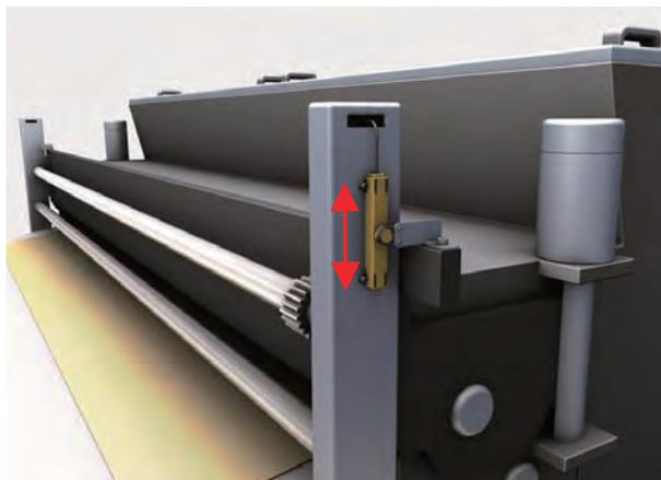
射出装置などの油圧シリンダストロークの位置検出
