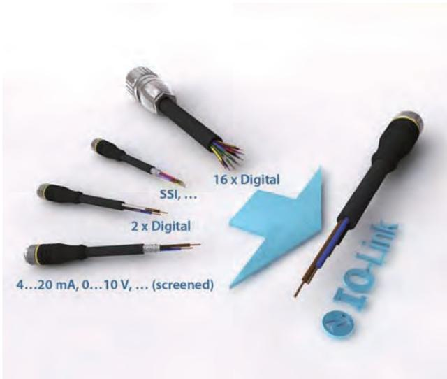
IO-Linkはセンサ・アクチュエータなど入出力機器に関するシリアルデジタル通信の国際規格です。IO-Linkに対応した入出力機器はIO-Linkデバイスと呼ばれ、上位側に位置するIO-Linkマスタと1対1の双方向デジタル通信が可能です。従来型センサの場合、スイッチング出力やアナログ出力など検出状態の情報のみ提供していますが、IO-Linkに対応したセンサは検出状態の他にセンサの個体情報や診断情報などをIO-Linkマスタ側へ提供することが可能です。IO-Linkはフィールドネットワークとの親和性が高く、PLCからIO-Linkデバイスのパラメータ設定や変更が可能になり、効率的な運用が実現できます。
