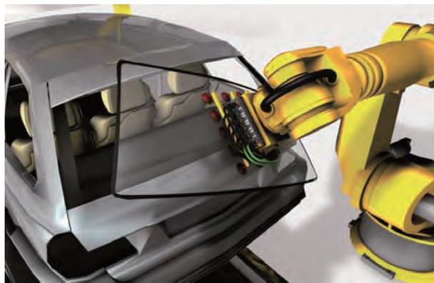
設置スペースが少ないロボットハンドにも搭載可能なコンパクトI/O TBEN-Sシリーズ。
