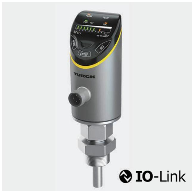
流速と温度を同時に測定するコンパクトフローセンサ。流速を常時 LEDバーディスプレイで表示。操作部にはタッチパッド式を採用し振動や衝撃に壊れやすい押し釦などの機構部品を排除。
