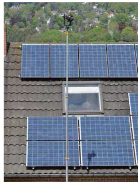
アルミニウム製のポールは全長約12 mで、ほとんどの住宅の屋根を検査できる。
