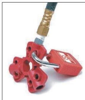
管内にロックアウトバルブを取り付けることなく、空気圧を遮断できます。弊社のエアカプラー用ロックアウトは、雄のエアカプラーに使用して、圧縮空気源から機器を遮断します。6.35mm (1/4"), 9.52mm (3/8") および 12.7mm (1/2") の雄のエアカプラーならほとんどどれにも対応します。ロックアウトの中央部分にエアホースを挿入できます。弊社の 38mm の真鍮の南京錠と併用します。
