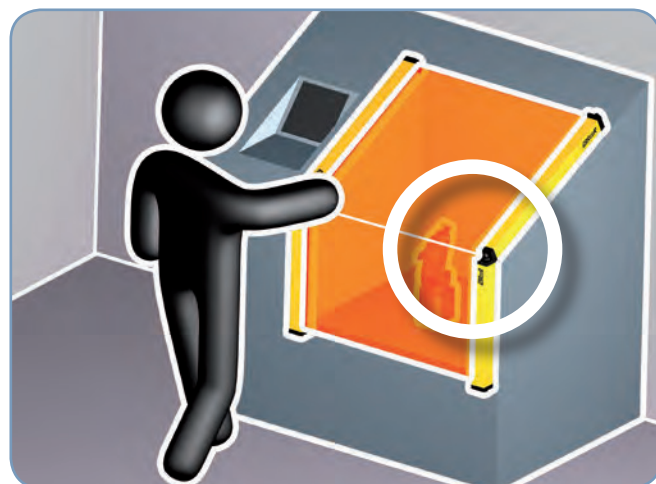
2つの保護領域が重なる部分でも最小検出体の 検知を維持できます(最大40 mm)。
