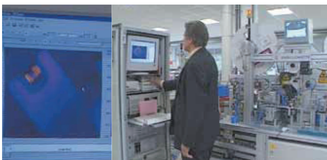
フリーシステムのサーモグラフィを使った完全自動化の品質管理体制 サーモグラフィで検出された抵抗器の不良
