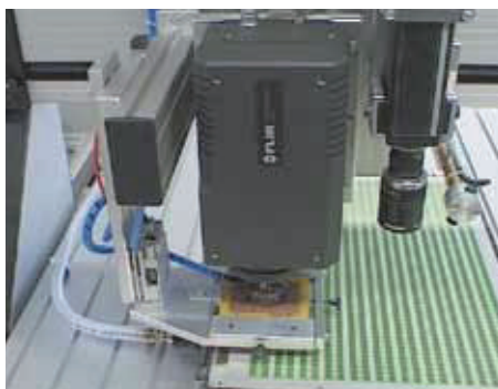
フリーシステムのサーモグラフィで部品をひとつひとつ検査する
