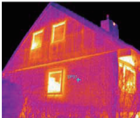
ロックウールのサーモグラフィトレーニングコースで使用された住宅の断熱不良を示す赤外線画像
