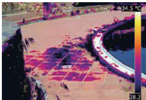
サーマルフュージョン機能や、ピクチャー・イン・ピクチャー機能を使い、熱画像と可視画像を統合した画像
