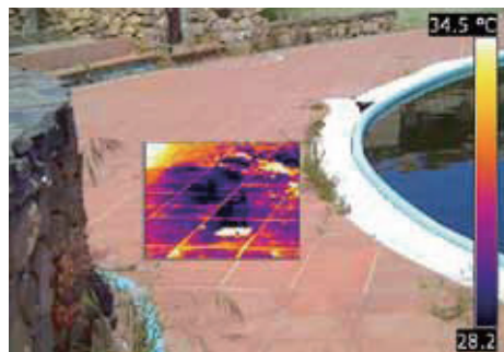
サーマルフュージョン機能や、ピクチャー・イン・ピクチャー機能を使い、熱画像と可視画像を統合した画像
