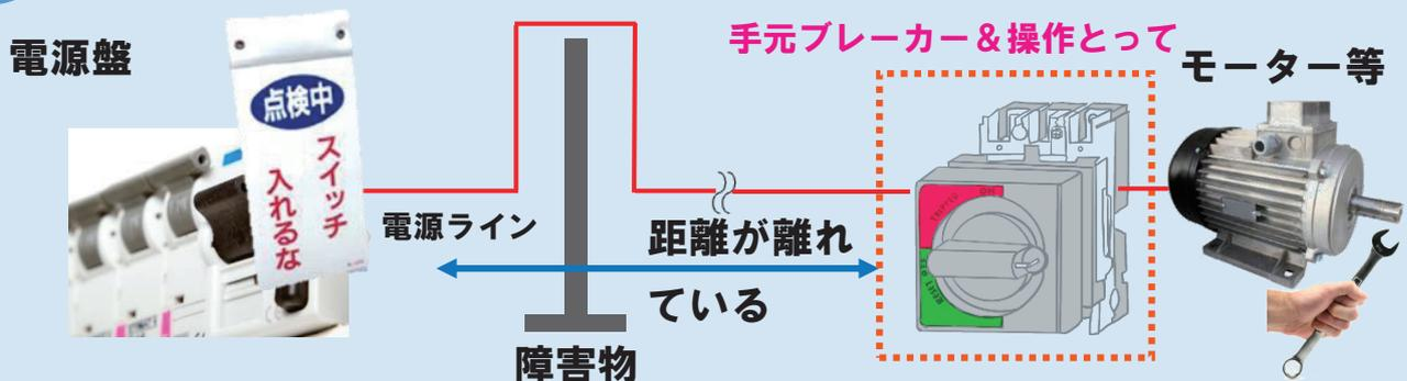
ブレーカー接点溶着時にハンドルをOFF側に操作できてしまう為
