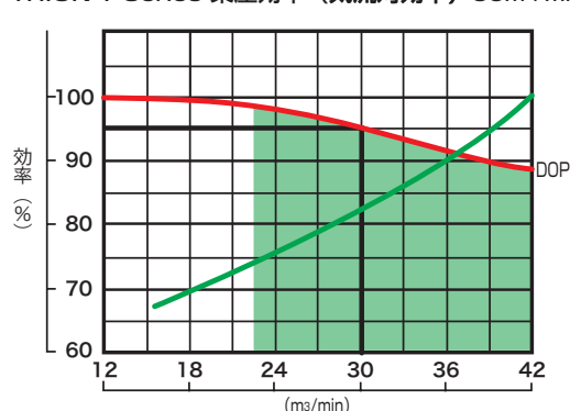
TRION T-Series 集塵効率 (気流対効率) 30m 3 /min 用セル
