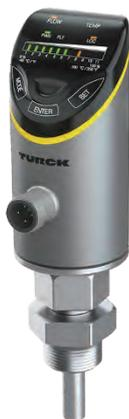
センサプローブとフローコントローラが一体化になったコンパクトフローセンサ。流速を常時LEDディスプレイで表示。視認性の高い二色LEDで動作状況の確認が容易。操作部はタッチパッド式を採用し、振動や衝撃に壊れやすい押しボタンなどの機構部品を排除。
