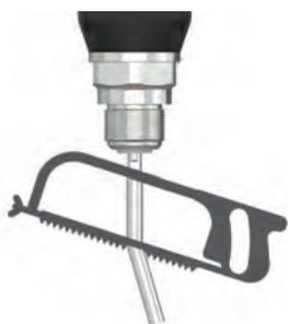
プローブロッドとコア軸シャルチューブは、任意の長さに切断でき、様々な用途に対応します。
