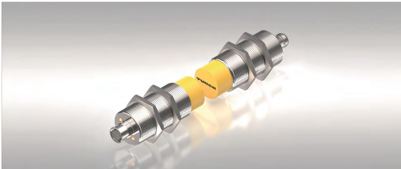
誘導型カプラNICは非接触で通信と給電を同時に行うことができる非接触接続デバイスです。機械的な接触がないため摩耗による劣化や故障がありません。コネクタケーブルと同様に簡単に接続でき、タクトタイムの向上を期待できます。物理的に接触の必要があるスリップリングやコネクタと比較して長寿命かつメンテナンスフリーのためメンテナンス工数の削減や設備停止時間の低減に貢献します。
