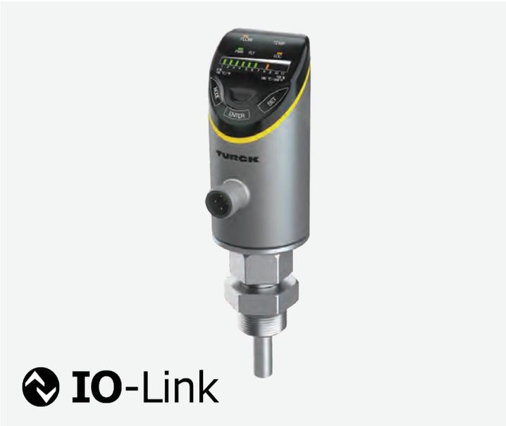
流速と温度を同時に測定するコンパクトフローセンサ。流速を常時LEDディスプレイで表示。操作部にはタッチパッド式を採用し振動や衝撃に壊れやすい押しボタンなどの機構部品を排除。
