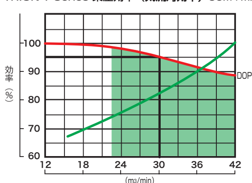
TRION T-Series 集塵効率 (気流対効率) 30m 3 /min 用セル
